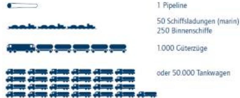
Vergleich des Transportaufwands für 1 Million Tonnen CO<sub>2</sub> per Pipeline, Schiff, Bahn oder Tankwagen[42]
